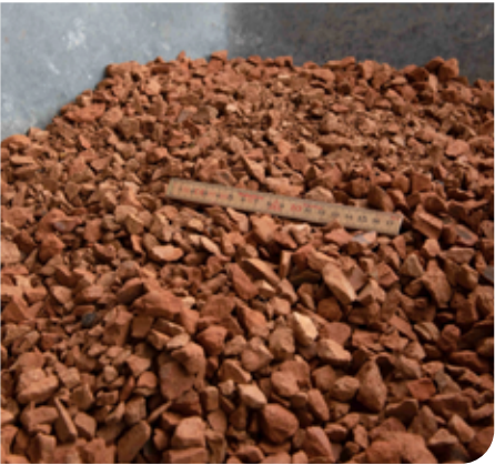
Ziegelgranulat Körnung des Granulats: 6–20 mm
