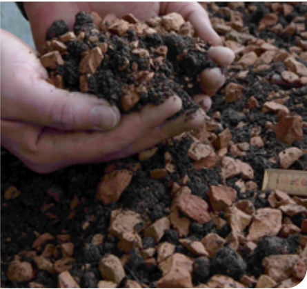
Baumgrubensubstrat Körnung des Substrates 0–25mm
