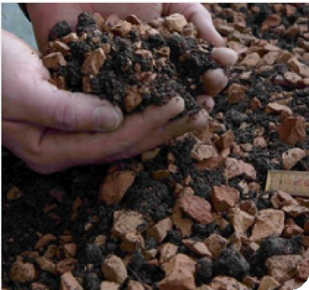
Baumgrubensubstrat Körnung des Substrates 0–25mm
